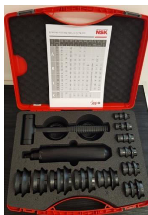
NSK alat za montažu ležaja (inercioni čekić)
