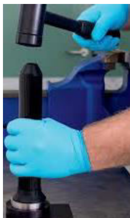
NSK alat za montažu ležaja (inercioni čekić)
