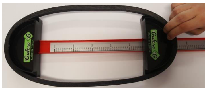
Metar za merenje dužine klinastih kaiševa
