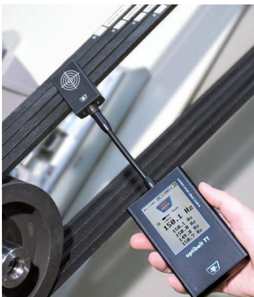
OPTIBELT uređaj za proveru zategnutosti kaiša
