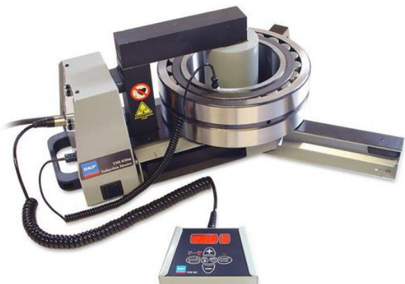
SKF indukcioni grejač za montažu ležaja do 30 kg
