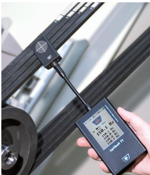
OPTIBELT uređaj za proveru zategnutosti kaiša
