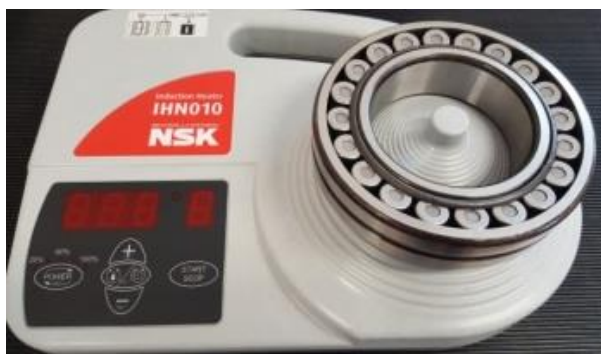
NSK indukcioni grejač za montažu ležaja do 10 kg
