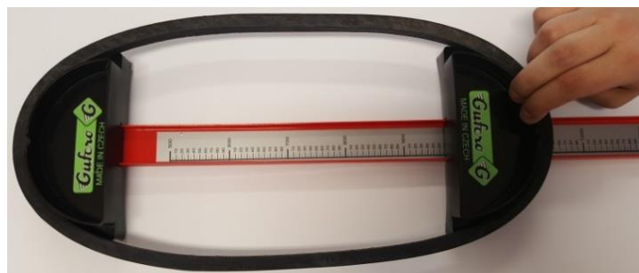
Metar za merenje dužine klinastih kaiševa
