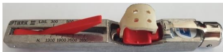
OPTIBELT mehanički uređaj za proveru zategnutosti kaiša
