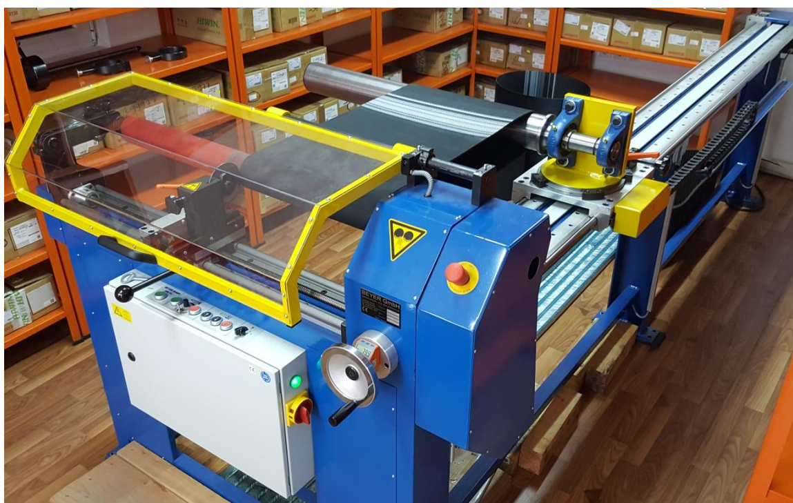
Mašina za sečenje zupčastih kaiševa iz rukavaca (na željenu širinu kaiša)
